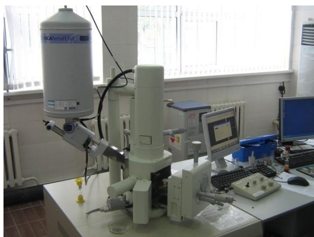
Рисунок б а – общий вид электронного микроскопа JSM-6390 LV JEOL (Япония) с системой энергодисперсионного микроанализа INCA ENERGY 250; б – проба на покровном стекле перед исследованием
